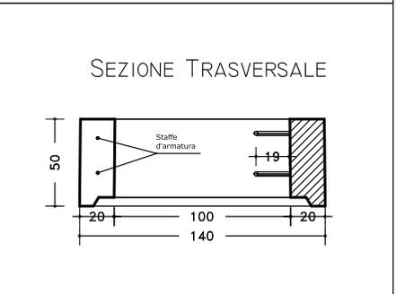
**Pozzetto di ispezione** prefabbricato in calcestruzzo vibrocompresso, per carichi stradali di Ia categoria secondo le vigenti NTC 2008, classe di resistenza C 28/35 (UNI 11104-2004), dimensioni interne cm 100x150, spessore pareti 20 cm, altezza utile interna 80 cm, incastro a bicchiere ed impronte di riduzione di spessore a frattura prestabilita per l'introduzione del tubo di attraversamento, se previste dal progetto, e fori per pedarele di discesa in acciaio.
