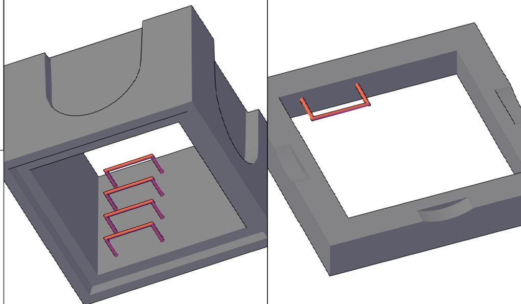
**Coperchio carrabile** prefabbricato in calcestruzzo armato vibrato, classe di resistenza C28/35 (UNI 11104-2004), per strade di 1ª categoria secondo le vigenti NTC 2008, di dimensioni cm 160x160 spessore 20 cm, predisposte per l'alloggiamento di chiusini in ghisa di luce interna cm 70 x cm 70, da collocare sui pozzetti ed anelli prefabbricati delle dimensioni esterne cm 190 x 140.
