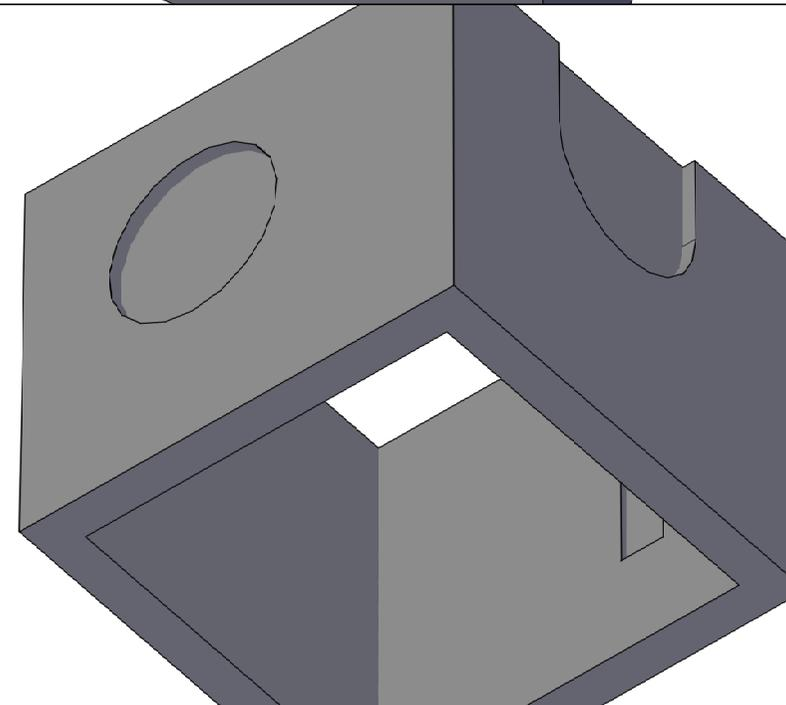
**Pozzetto d'ispezione** realizzato in calcestruzzo vibrocompresso classe di resistenza C 20/25 (UNI 11104-2004), dimensioni interne cm 30x30, spessore pareti 3 cm, altezza utile 27 cm, incastro in aderenza ed impronte di riduzione di spessore a frattura prestabilita per l'introduzione del tubo di attraversamento se previste dal progetto, e fori per pedanole di discesa in acciaio. Gli elementi saranno tra loro sigillati e stuccati con l'interposizione di malta cementizia.
