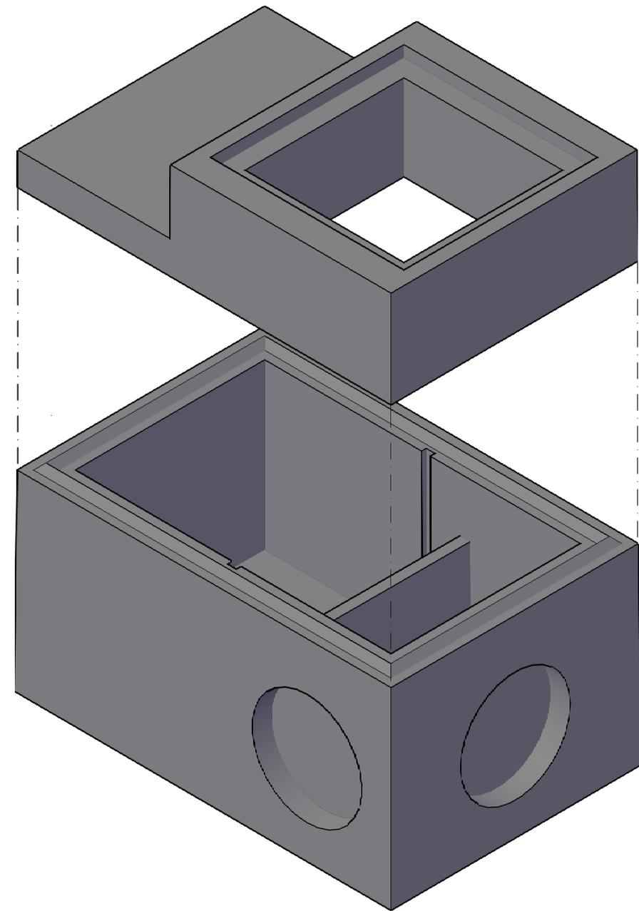
Caditoia completa, prefabbricata in calcestruzzo vibrocompresso, a doppio sifone dimensioni nominali di 60x100 cm interno, con prolunga 50x50 integrata nel coperchio, spessore 10 cm, confezionata con cemento tipo II/A-LL 42,5R, con classe di resistenza C30/37 e classe di esposizione XC3 (resistenza alla corrosione da carbonatazione), XF3 (resistenza all'attacco gelo/disgelo), slump S1 terra umida, grado di finitura SCABRA, portante e da giuntare con malta cementizia in opera.
