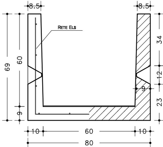
Elementi prefabbricati in c.a.v per la distribuzione di servizi (energia elettrica, telecomunicazioni, acqua, ecc.) costituito da cunicoli con sezione ad "U" e solette di copertura, classe resistenza C25/30 Mpa (UNI 11104-2004), dimensioni esterne cm 69x80, spessore pareti 10 cm, altezza utile interna 60 cm, incastro maschio-femmina ed impronte per la movimentazione ed il posizionamento del prefabbricato in sicurezza.
