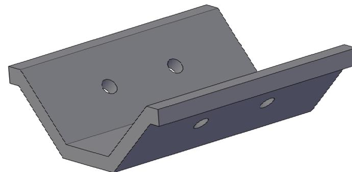
Fornitura e posa in opera di elementi prefabbricati in calcestruzzo armato con rete elettrosaldata, vibrato avente classe di resistenza C25/30 (UNI 11104-2004) e prodotto da azienda certificata ISO 9001-2015, a sezione trapezia delle dimensioni di base 30 cm, altezza 30 cm, bocca 90 cm e lunghezza minima 240 cm, per il rivestimento di fossi di guardia e cunette.
