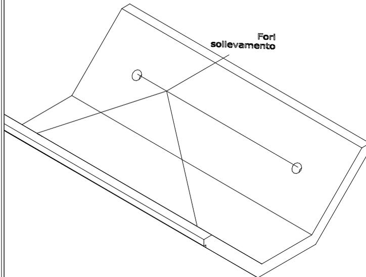
Fornitura e posa in opera di elementi prefabbricati in calcestruzzo armato con rete elettrosaldata, vibrato avente classe di resistenza C..... (UNI 11104-2004) e prodotto da azienda certificata ISO 9001-2015, a sezione trapezia delle dimensioni di base 50 cm, altezza 50 cm, bocca 150 cm e lunghezza minima 240 cm con giunto maschio-femmina, per il rivestimento di fossi di guardia e cunette.
