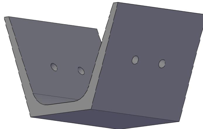
Fornitura e posa in opera di elementi prefabbricati in calcestruzzo armato con rete elettrosaldata, vibrato avente classe di resistenza C25/30 (UNI 11104-2004) e prodotto da azienda certificata ISO 9001-2015, a sezione trapezia delle dimensioni di base 60 cm, altezza 85 cm, bocca 140 cm e lunghezza minima 230 cm, per il rivestimento di fossi di guardia e cunette.
