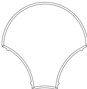
MASSELLO DI CALCESTRUZZO PREFABBRICATO CON CERTIFICAZIONE DI PRODOTTO, CONFORME A NORMA UNI EN 1338, PRODOTTI DA AZIENDA DOTATA DI SISTEMA DI QUALITÀ CERTIFICATO, REALIZZATI IN CALCESTRUZZO VIBROCOMPRESSO AD ALTA RESISTENZA, DI MASSA VOLUMICA > 2200 KG/MC, RESISTENZA CARATTERISTICA A TRAZIONE INDIRETTA > 3,6 MPA. , DELLO SPESSORE DI CM 6,0, [COLORATI CON OSSIDI INORGANICI]. ASSORBIMENTO D'ACQUA < 6% .
