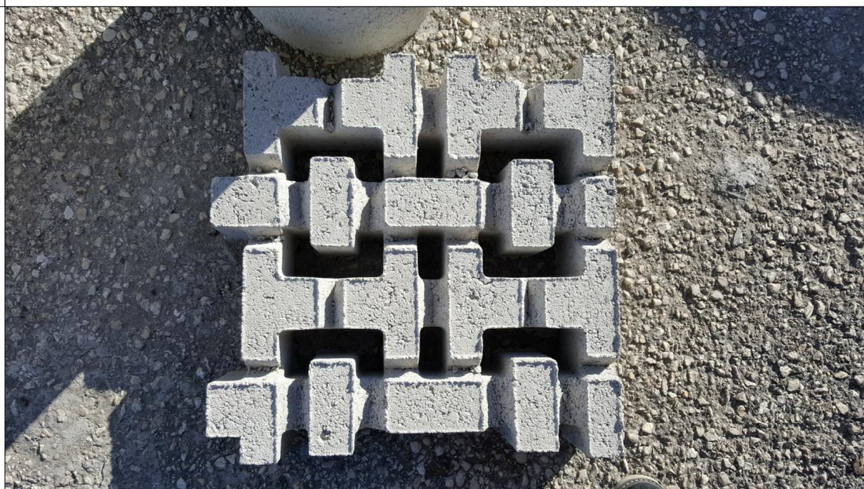
**MONOSTRATO:** GRIGLIATO ERBOSO COMPOSTO DA BLOCCHI PREFABBRICATI IN CALCESTRUZZO A MONOSTRATO, DI FORMA POLIGONALE, ISCRITTI IN UN RETTANGOLO DI LATI 500 MM X 500 MM, SPESSORE DI 120 MM. I BLOCCHI PRESENTANO AL LORO INTERNO NOVE FORI PASSANTI 6 DI FORMA POLIGONALE E 3 DI FORMA RETTANGOLARE.
